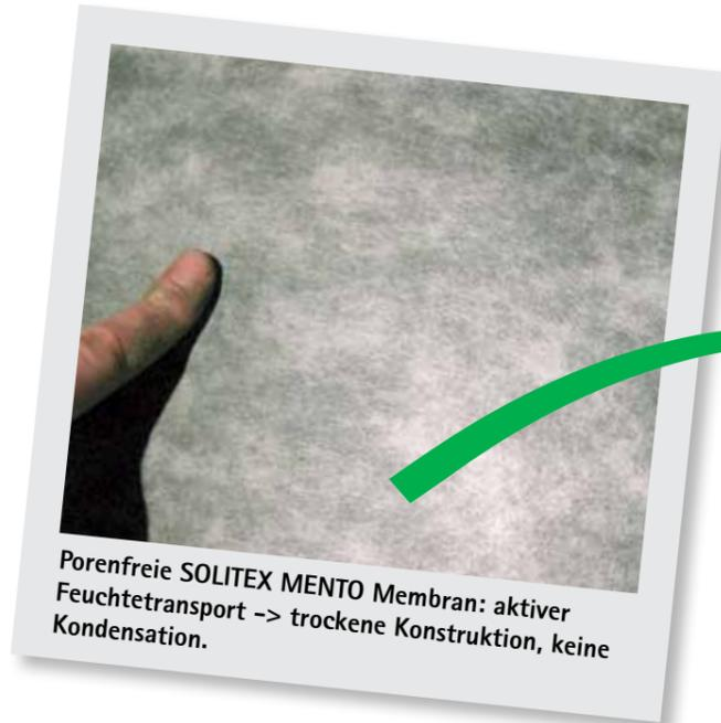
Porenfreie SOLITEX MENTO Membran: aktiver Feuchtetransport -> trockene Konstruktion, keine Kondensation.
