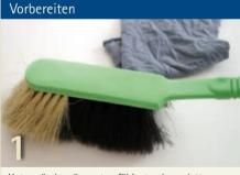
Untergründe müssen tragfähig, trocken, glatt, staub-, silikon- und fettfrei sein. Untergründe abfegen, ggf. absaugen und abwischen.
